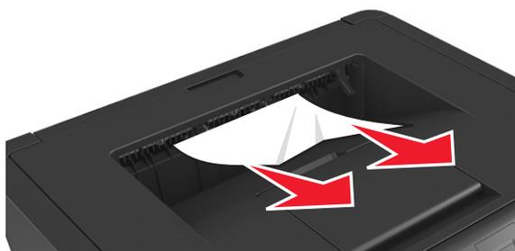
2 En el panel de control de la impresora, seleccione **Siguiente** > **OK** > **Elimine el atasco**, pulse **Aceptar** > **OK** para borrar el mensaje y seguir imprimiendo.
