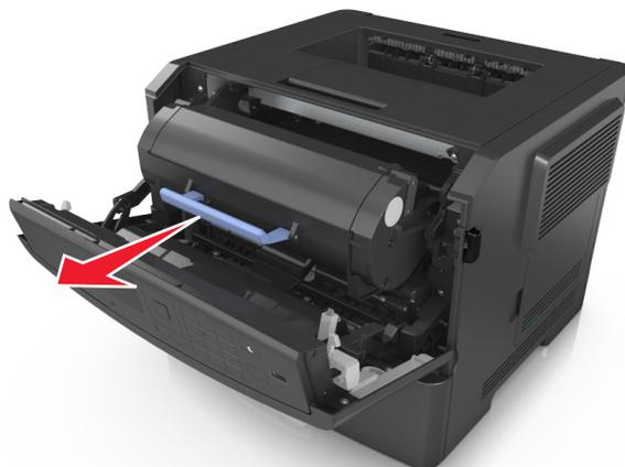
3 Levante la palanca azul y, a continuación, extraiga la unidad de imagen de la impresora.
